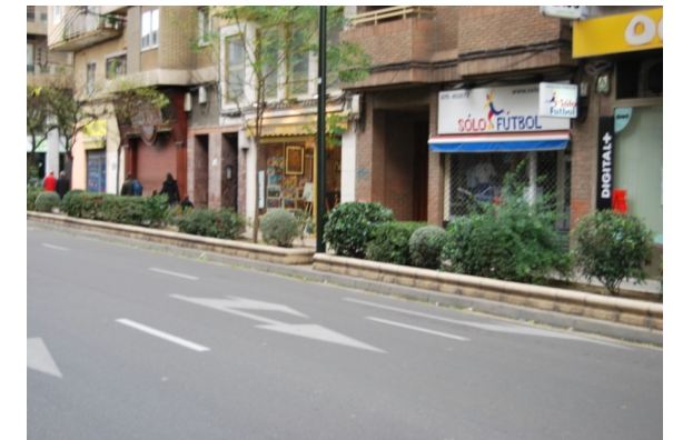
La jardinera continua se interrumpe tan sólo por pasos de peatones y puntualmente para la colocación de los báculos. La jardinera elevada aísla del tráfico pero también constituye una barrera a la movilidad.
